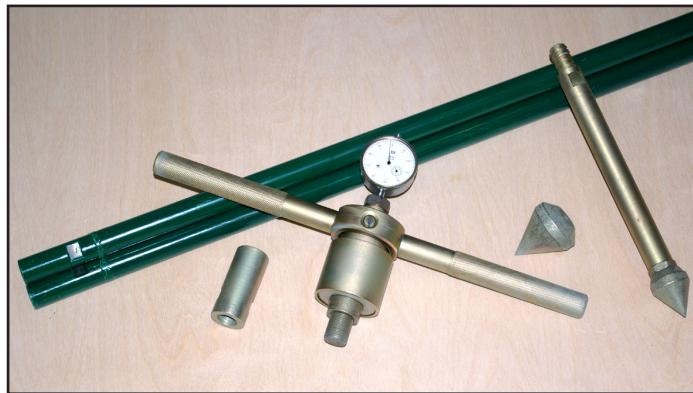
В состав комплекта ручного пенетрометра РП-1 входит следующий инструмент:
