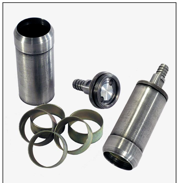
Грунтоотборник предназначен для отбора проб грунтов ненарушенной структуры при ручном бурении геологических скважин. Внешний вид грунтоотборника показан на рисунке.
